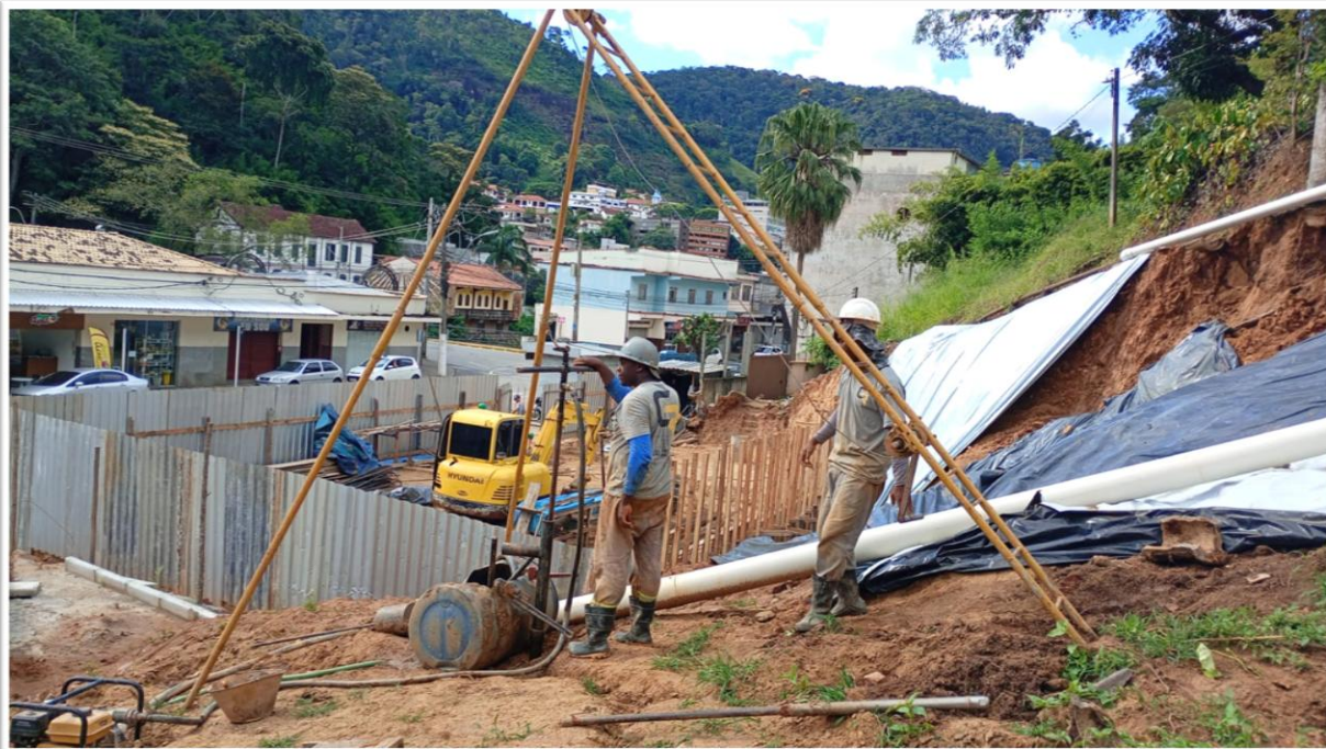
Figura 1 – Sondagem a percussão sendo realizada.
